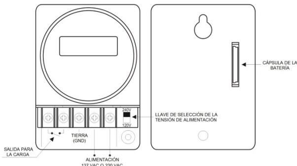
Fig. 03 - Vista frontal y posterior del Timer TM-6331
