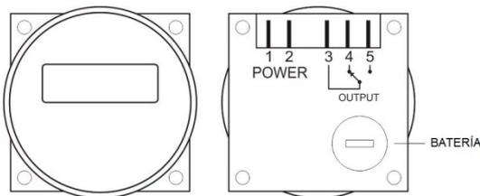
Fig. 02 - Vista frontal y posterior del Timer TM-619
