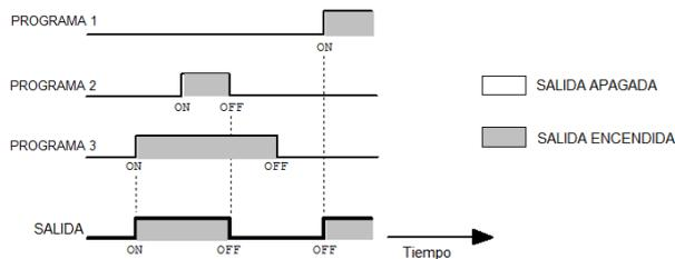
Fig. 01 - Comportamiento de la salida con programas sobrepuestos
