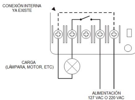
Fig. 07 – Modelo de conexión del Timer TM-6331
