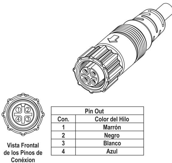
Fig. 6 – Pinos de conexión para montaje del cable M12
