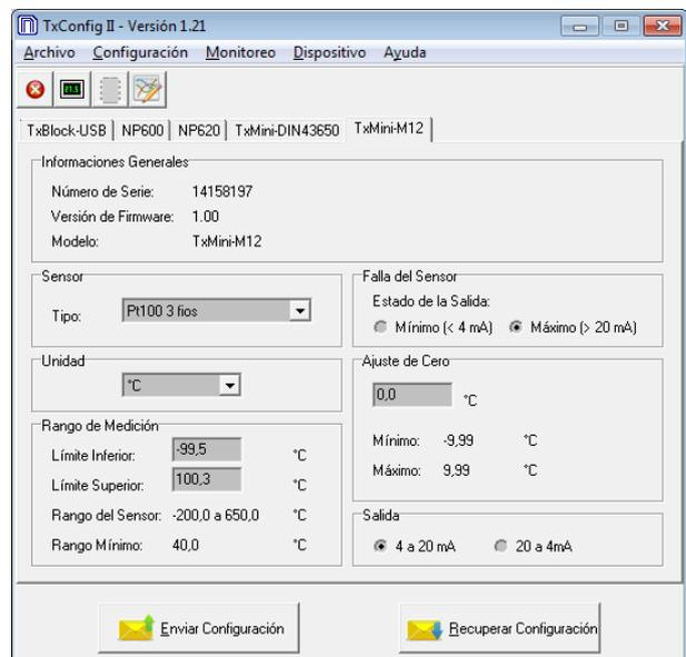
**Fig. 1** – Pantalla principal del software **TxConfig II**
