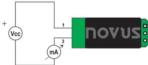
Fig. 4 – Diagrama de Conexión de TxMini / TxMini-M12
