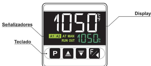
Fig. 02 - Identificación de las partes del panel frontal
